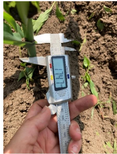
c) Messung Stängeldurchmesser mittels elektrischer Schieblehre
