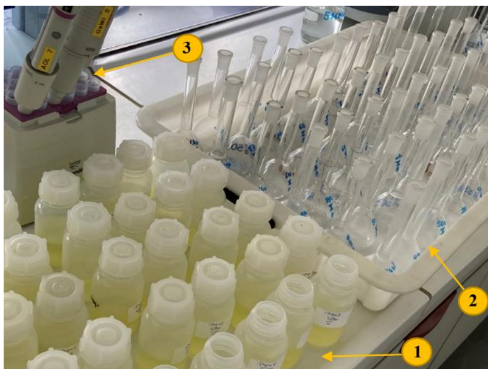
Abb. 11: Extrahierte Proben in Falcons (1), 50 ml Messkolben zum Ansetzen der im Photometer zu messenden Lösungen (2), Pipetten mit dazugehörigen Pipettenspitzen (3) (THO SEETH 2022).
